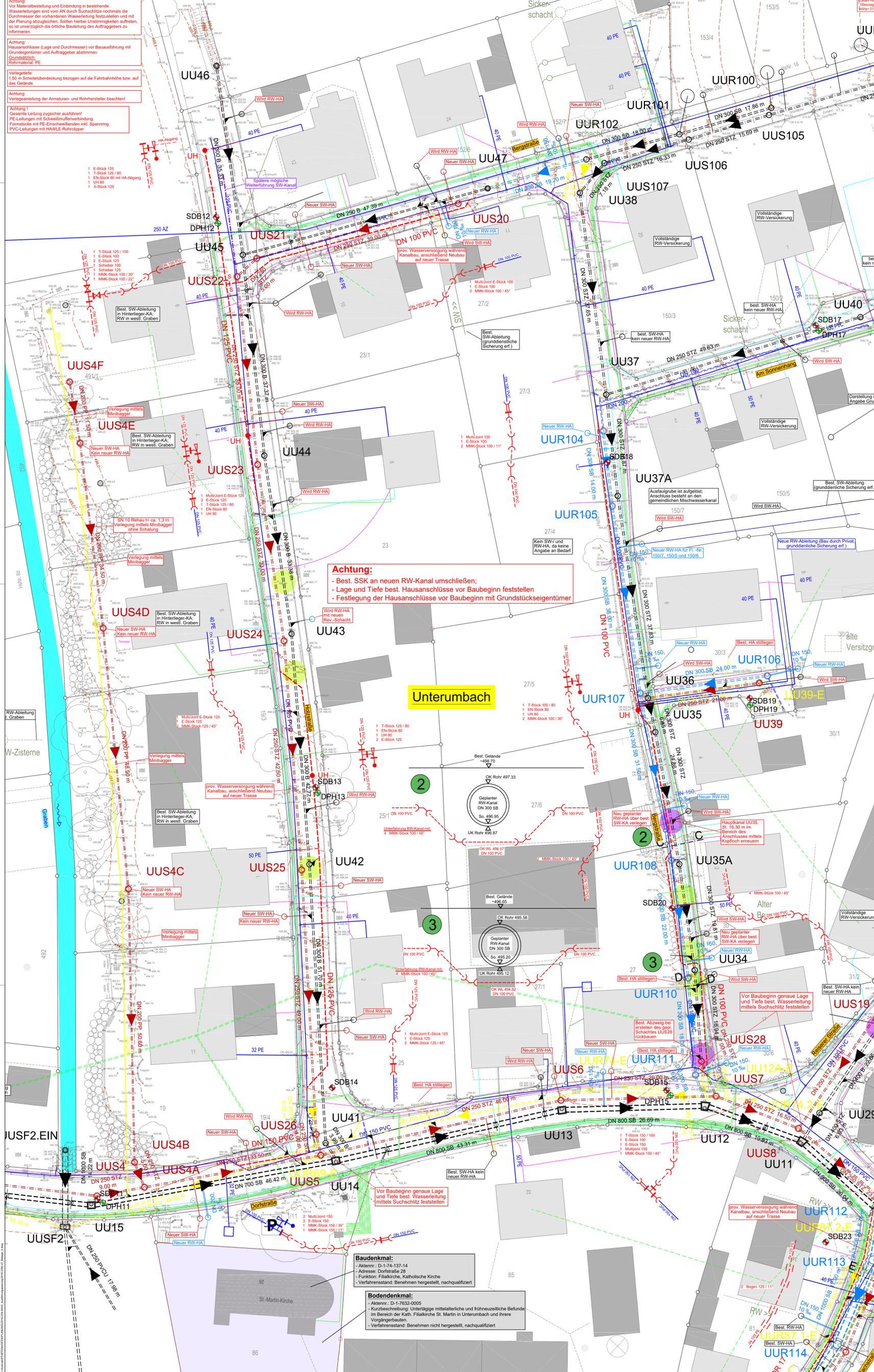
**Achtung:** Vor Materialbestellung und Einbindung in bestehende Wasserleitungen sind vom AN durch Suchschlitze nachweislich die Durchmesser der vorhandenen Wasserleitungen festzustellen und mit der Planung abzugleichen. Sollten hier Unstimmigkeiten auftreten, so ist unverzüglich die örtliche Bauleitung des Auftraggebers zu informieren.
