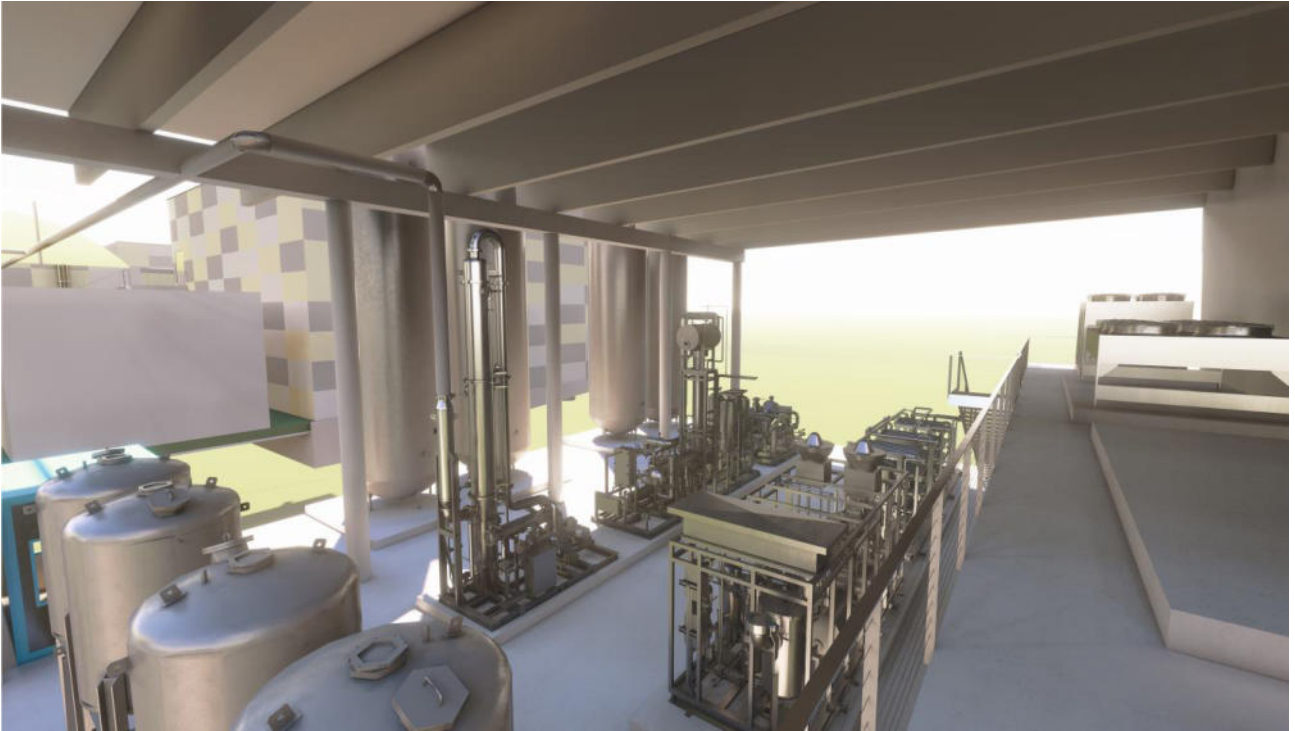
Abb. 8 Ansicht der Biogas Upgrading Anlagen und CO2 Verflüssigungsanlage
